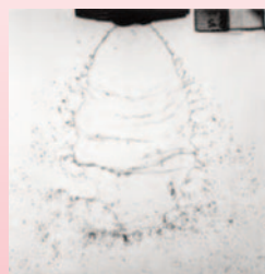
Spritzung mit Standard Flachstrahldüse 0,5 % Netzmittel A bei 1,0 bar
